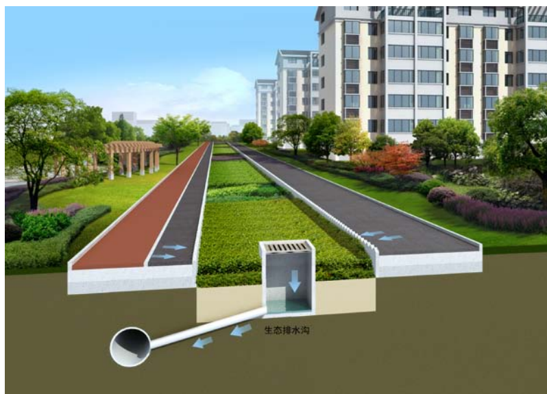
图 7-2 生态滤水带构造图
